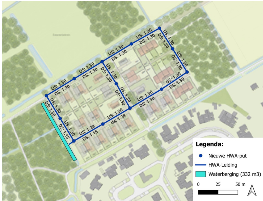
Afbeelding 5.5 Overzicht HWA-ontwerp. US = bovenstrooms, DS = benedenstrooms hoogteligging leidingen b.o.b. in m +NAP
