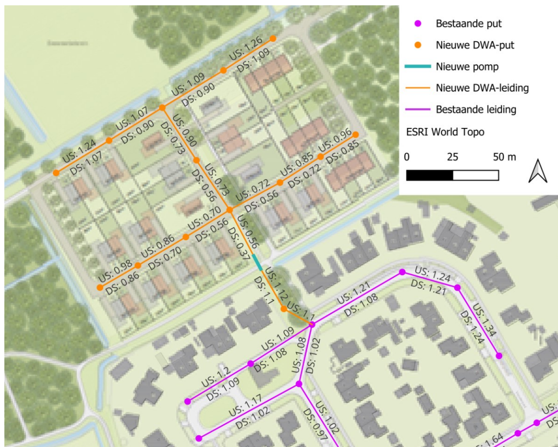
Afbeelding 4.2 US = bovenstrooms, DS = benedenstrooms hoogteligging leidingen b.o.b. in m +NAP
